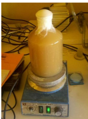
Figure II-8 : Dispositif expérimental pour la mesure de la vitesse de dénitrification.
