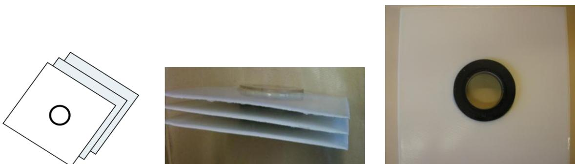
Figure II-3 : Le module membranaire.
