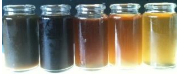
Figure III.3 : Abattement de couleur en fonction du seuil de coupure des membranes (digestat BIOD T1 brut, ultrafiltré à 300 kDa, ultrafiltré à 50 kDa (TERR T2 ici), ultrafiltré à 8 kDa et 1 kDa, respectivement de gauche à droite).
