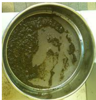
Figure II.5 : Résultat du tamisage du digestat BIOD T4.
