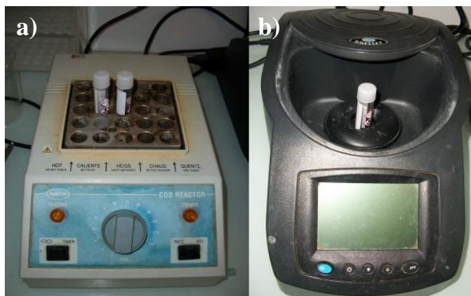
Figure II.2 : Photographies a) chauffage des tubes DCO, b) spectrophotomètre.
