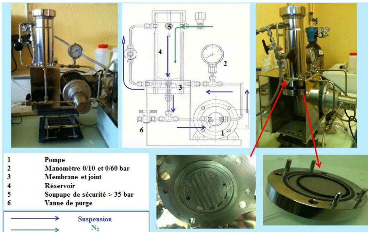
Figure II.12 : Unité pilote de séparation pour NF et OI.
