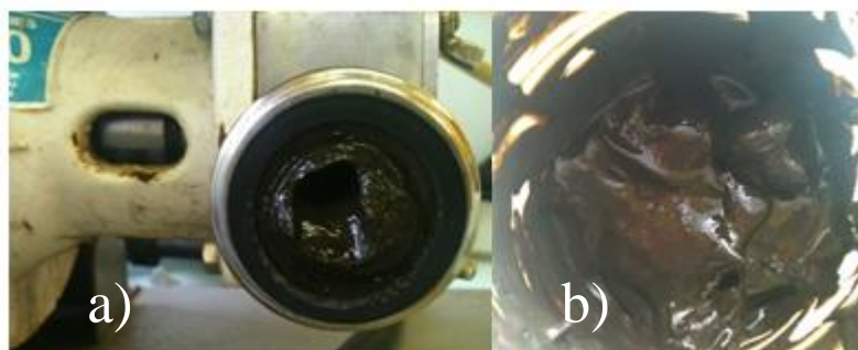
Figure III.13 : Photographies des digestats a) BIOD T2 et b) AGRI 2 T3 tamisés à un FCV au environ de 1,5.
