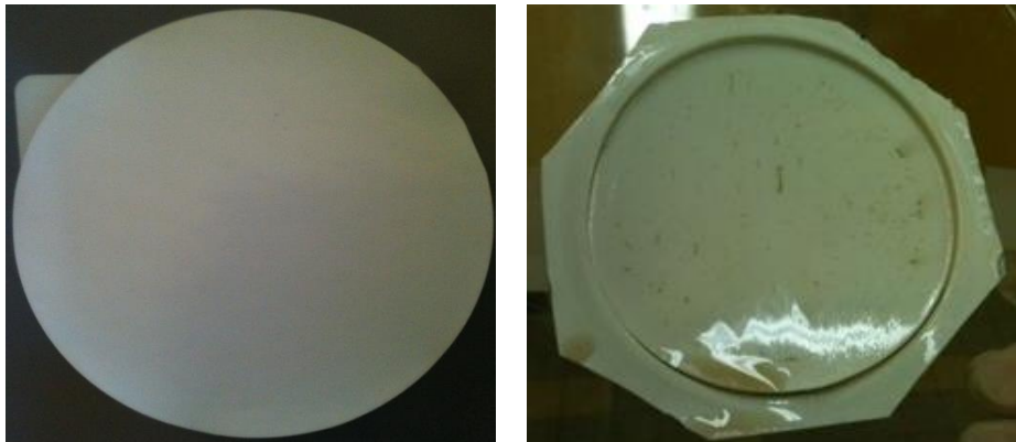
Figure IV.7 : Observation de salissures en surface membranaire en fin d'opération (membrane propre à gauche, membrane sale à droite).
