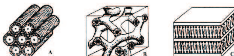
Figure II.7 : Les différents types de matrice de silice A)MCM41 B)MCM48 et C) MCM50
