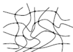
Figure 27: représentation d'un système macromoléculaire sous forme d'un réseau dense en points de réticulation
