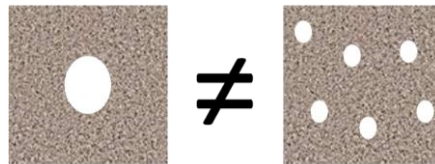
Figure 44 : Schéma montrant que deux spécimens peuvent avoir le même volume de contenu libre, mais les distributions sont différentes. Par exemple, un volume de 18 \text{ cm}^3 peut être représenté par 1 trou de 18 \text{ cm}^3 , ou de 6 trous de 3 \text{ cm}^3 chacun [77].
