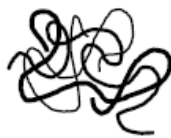
Figure 26: représentation sous forme de pelote statistique d'un système macromoléculaire
