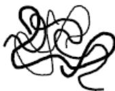
**Figure 26:** représentation sous forme de pelote statistique d'un système macromoléculaire
