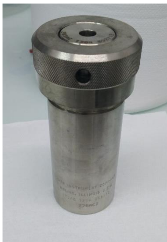
Figure 3 : Réacteur sous pression utilisé pour les synthèses hydrothermales et solvothermales.
