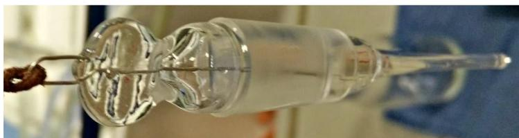
Figure 5 : Electrode réversible à hydrogène – un fil de platine piégé dans une pièce creuse en verre.
