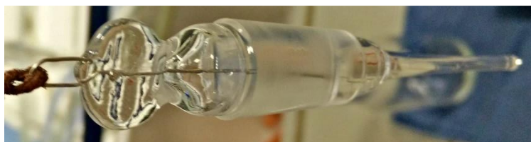
Figure 5 : Electrode réversible à hydrogène – un fil de platine piégé dans une pièce creuse en verre.
