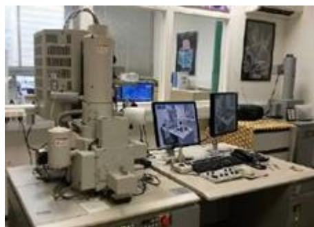
Figure II.A2 : Microscope électronique à balayage (Hitachi, S-4800).
