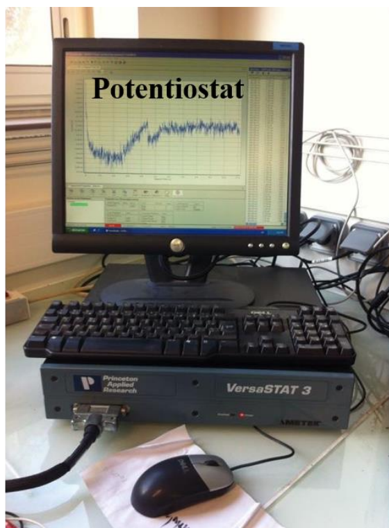
Figure II.2 : Système utilisé pour les différents types d'électrodépôt.
