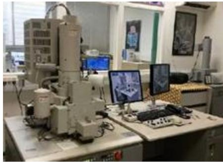
**Figure II.A2** : Microscope électronique à balayage (Hitachi, S-4800).
