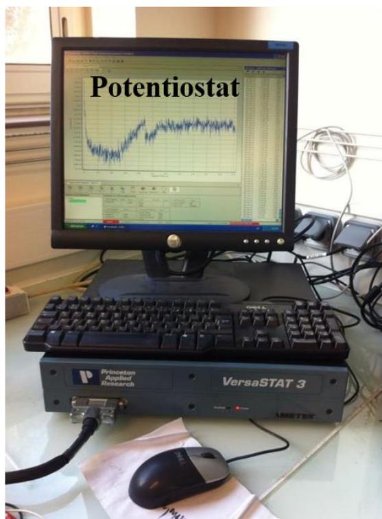
Figure II.2 : Système utilisé pour les différents types d'électrodépôt.
