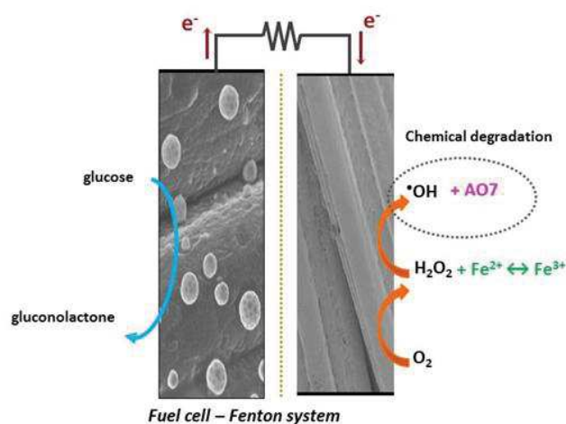
Figure 6.1. Schéma de principe du système Fuel Cell-Fenton.
