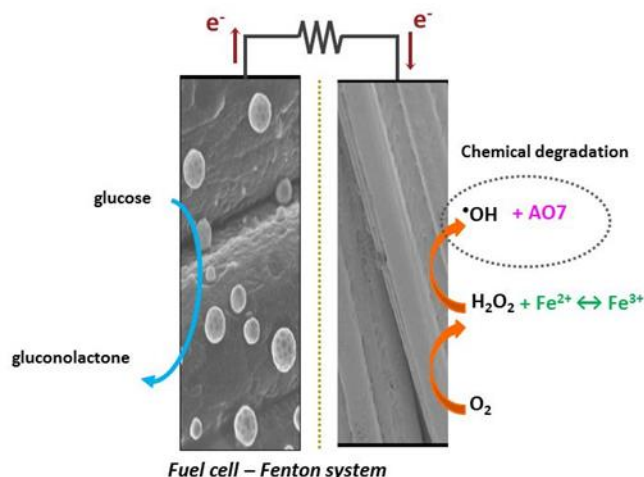
Figure 6.1. Schéma de principe du système Fuel Cell-Fenton.
