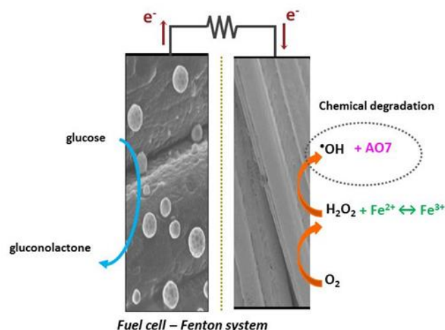
Figure 6.1. Schéma de principe du système Fuel Cell-Fenton.
