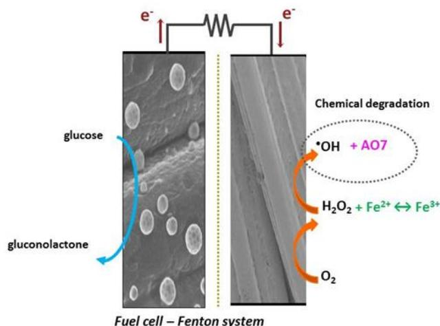
Figure 6.1. Schéma de principe du système Fuel Cell-Fenton.
