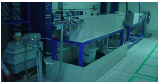
Cuve de cataphorèse
