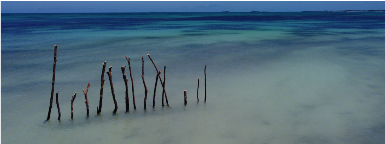
FIGURE 18 : Photo in-situ d'un test d'ancrage réalisé dans l'avant côte devant l'église de Saint Joseph. Ces pieux ne constituent absolument pas la solution de protection (contrairement à l'idée qui est véhiculée sur place). Il s'agit simplement de tests d'ancrage permettant de vérifier qu'un ensouillage des pieux dans environ 1 à 1.5 m de sédiment suffit à les rendre non remobilisables par les événements tempétueux.
