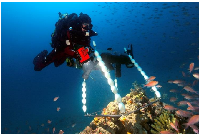
Figure 5 : Plongeur en recycleur (circuit fermé) réalisant des quadrats photographiques sur un récif coralligène selon la méthode de Deter et al. (2012b). © Andromède océanologie
